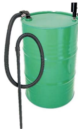
Skruva i venturipumpen i lockets 3/4" hål och anslut tryckluft.
